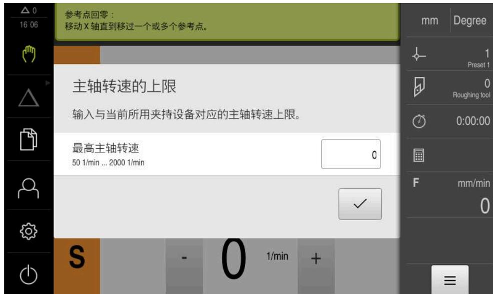
图 41: 主轴转速的上限对话框
