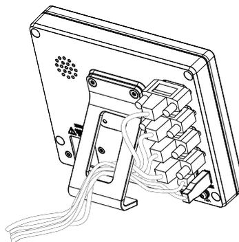
图 16: 电缆在单位支架上的走线
