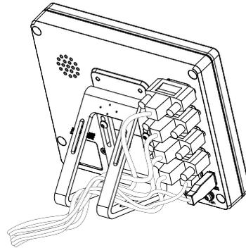
图 18: 电缆在双位支架上的走线
