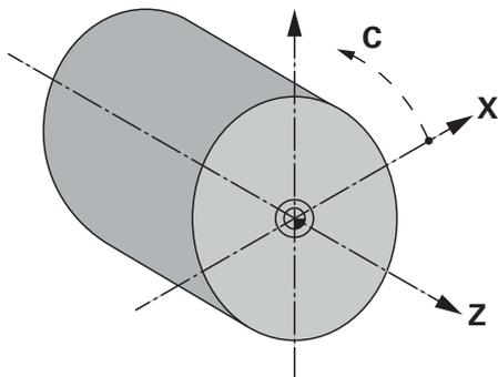
图 25: 矩形坐标系与工件间的关系
