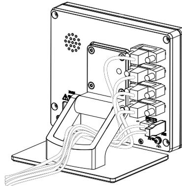
图 20: 电缆在多位支架上的走线
