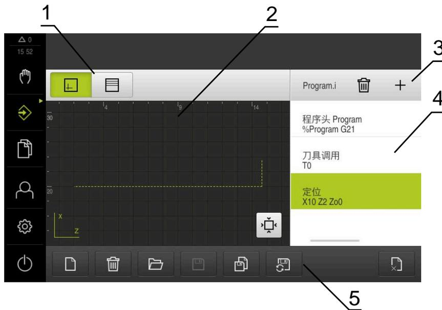
图 8: 已打开仿真窗口的**程序编辑**菜单
