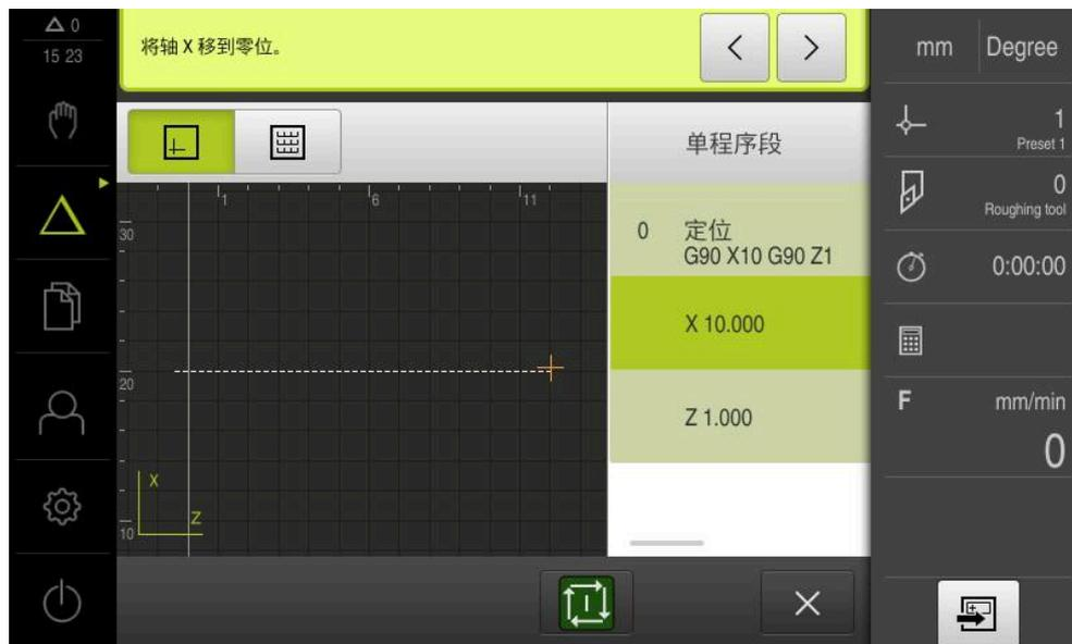
图 48: 举例 – 带缩放系数MDI程序段的执行
