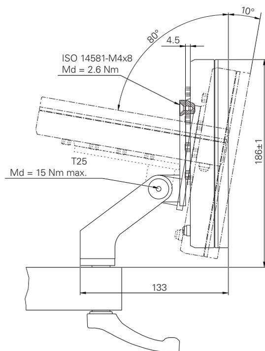
图 39: 带多位安装座的产品尺寸
