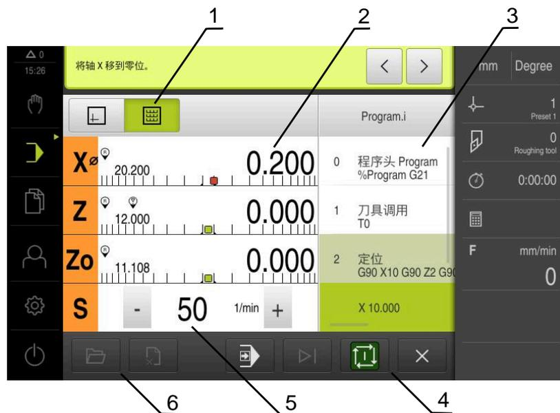
图 49: 程序运行操作模式下的程序举例
