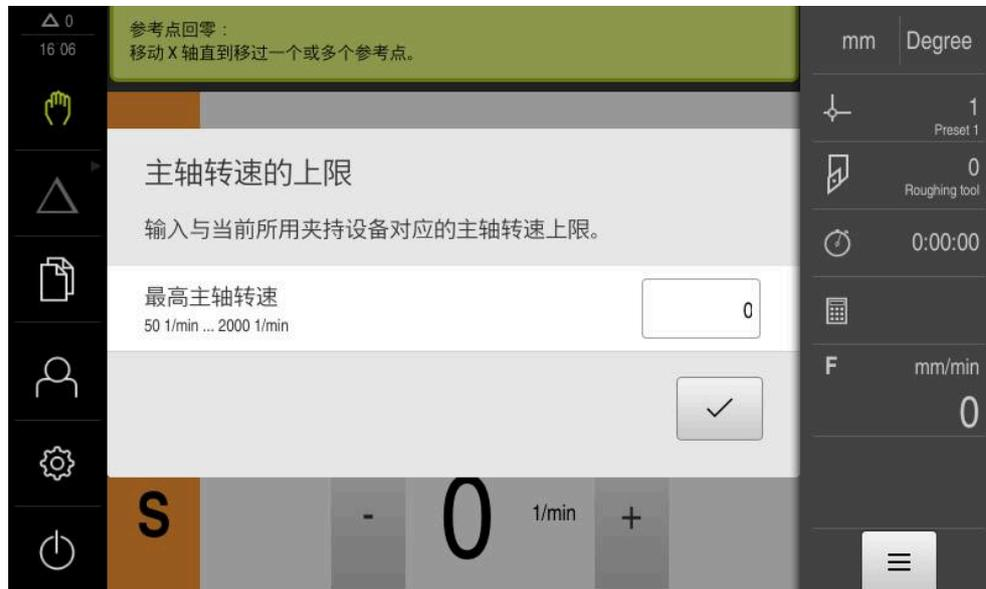
图 43: 主轴转速的上限对话框
