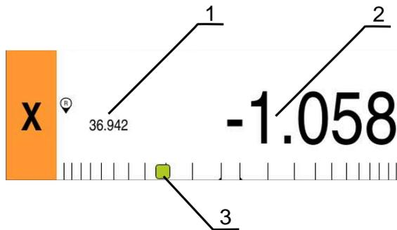
图 46: 带图形定位辅助的余程位置视图
