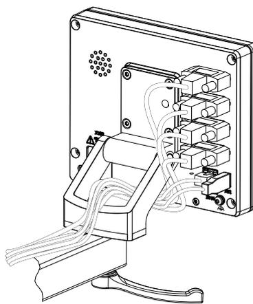
图 22: 电缆在多位安装座上的走线
