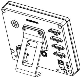
Illustration 16 : Appareil monté sur le socle Single-Pos
