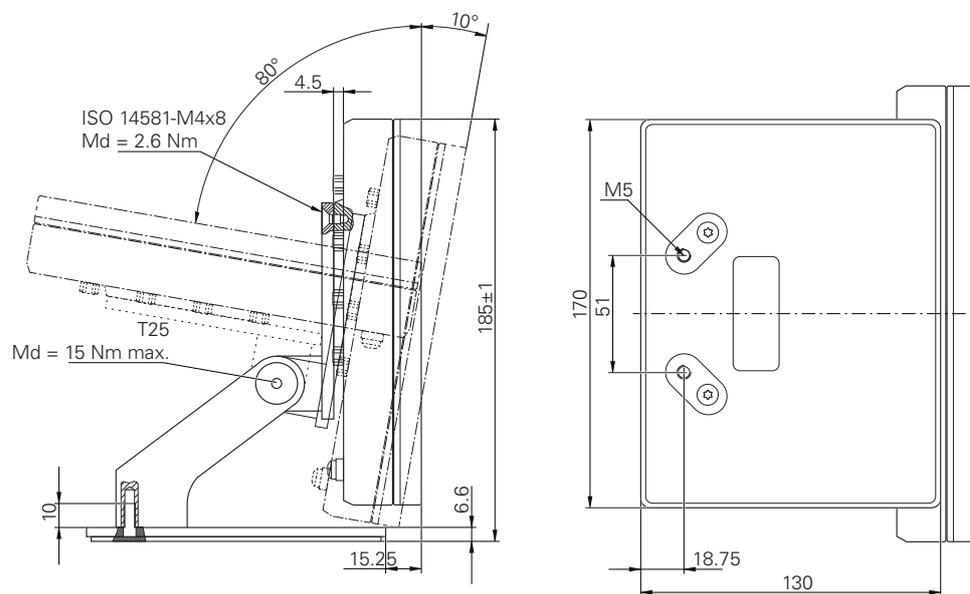
Illustration 40 : Dimensions de l'appareil avec le socle Multi-Pos
