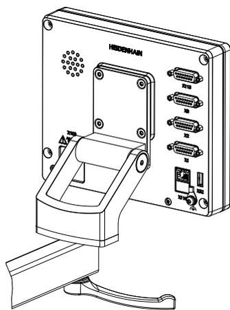
Illustration 22 : Appareil monté sur le support Multi-Pos
