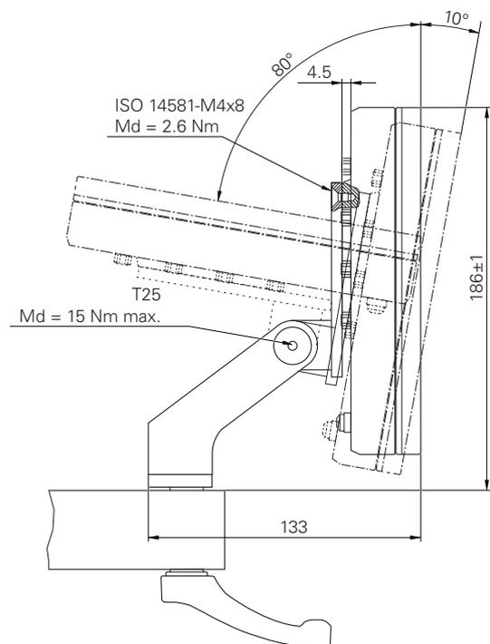
Illustration 41 : Dimensions de l'appareil avec le support Multi-Pos
