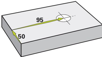
Illustration 64 : Exemple de pièce – Usinage d'un trou traversant
