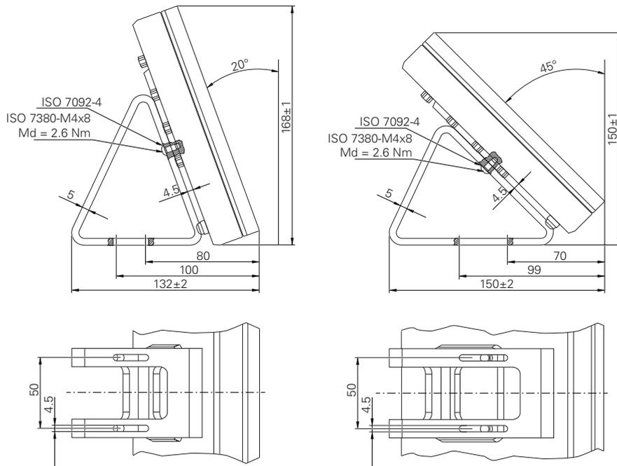
Illustration 39 : Dimensions de l'appareil avec le socle Duo-Pos
