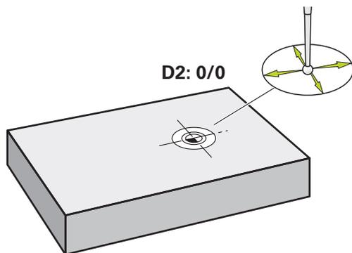
Illustration 67 : Exemple de pièce – Détermination du point d'origine D2
