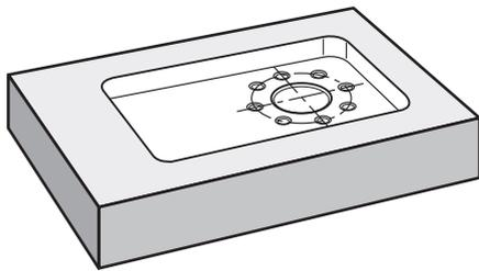
Illustration 68 : Exemple de pièces – Usinage d'un cercle de trous
