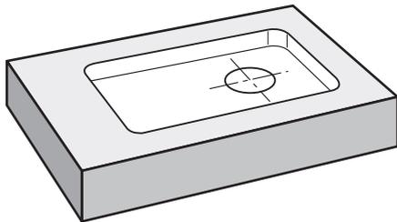
Illustration 65 : Exemple de pièce – Usinage d'une poche rectangulaire
