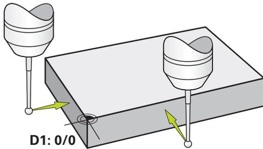
Illustration 63 : Exemple de pièce – Détermination du point d'origine D1
