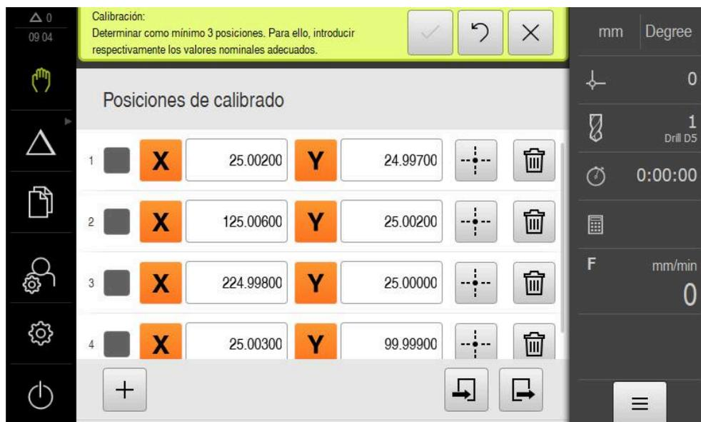
Figura 36: Paso **Posiciones de calibrado**
