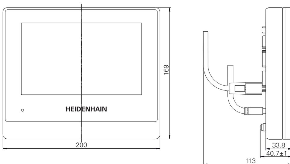
Figura 45: Mediciones de la carcasa de aparatos con ID 1089178-xx
