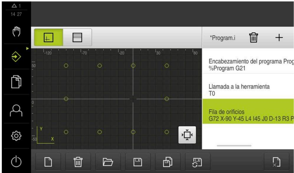
Figura 76: Pieza de ejemplo - Ventana de simulación
