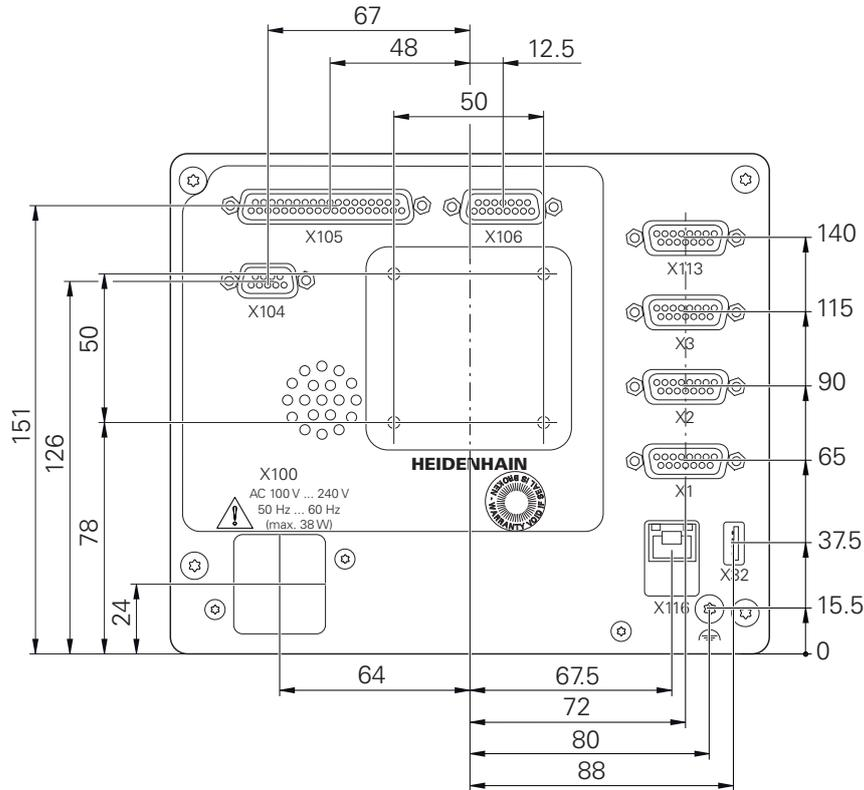
Figura 48: Mediciones de la parte trasera de aparatos con ID 1089179-xx
