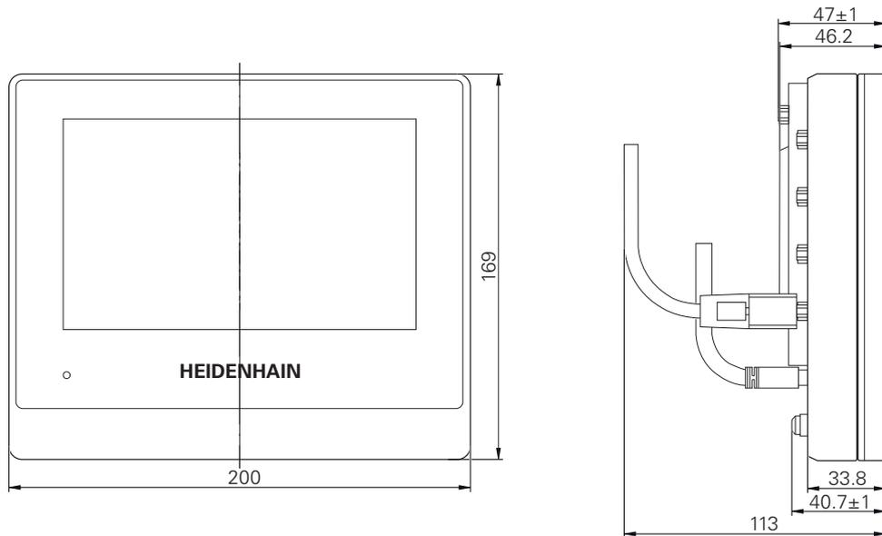
Figura 46: Mediciones de la carcasa de aparatos con ID 1089179-xx
