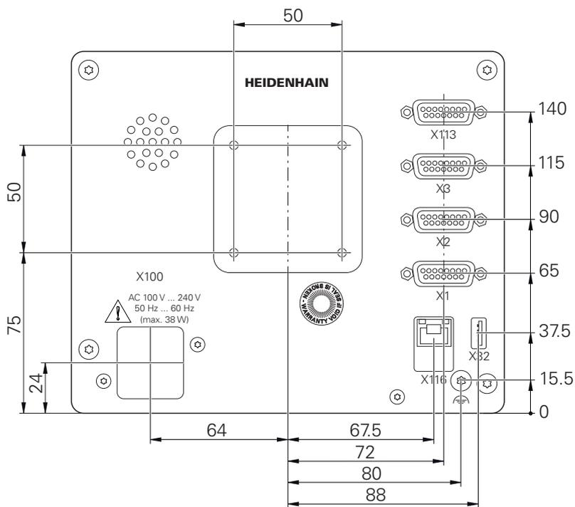
Figura 47: Cotas de la parte trasera de los equipos con ID 1089178-xx
