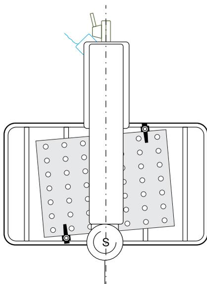
Figura 32: Placa perforada en la mesa de trabajo
