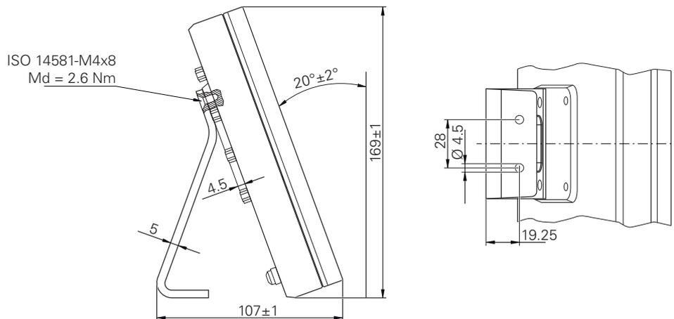
Figura 49: Medidas del equipo en soporte bisagra Single-Pos
