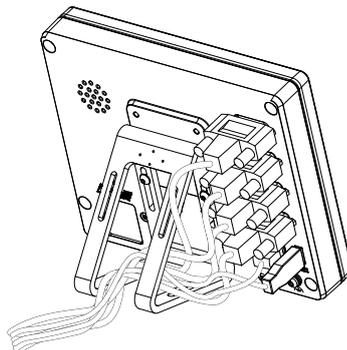
Figura 16: Cableado en soporte bisagra Duo-Pos
