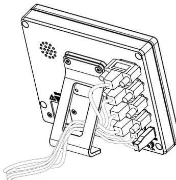
Figura 14: Cableado en soporte bisagra Single-Pos
