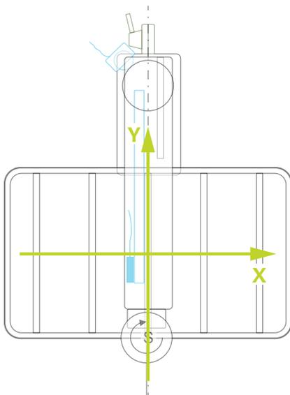
Figura 38: Vista en planta de una taladradora radial de alta velocidad con dirección de contaje
