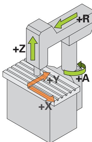
Figura 25: Configuración de la taladradora radial de alta velocidad
