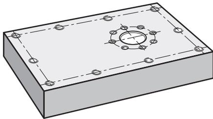
Figura 75: Pieza de ejemplo – Programar un círculo de taladros y una fila de taladros
