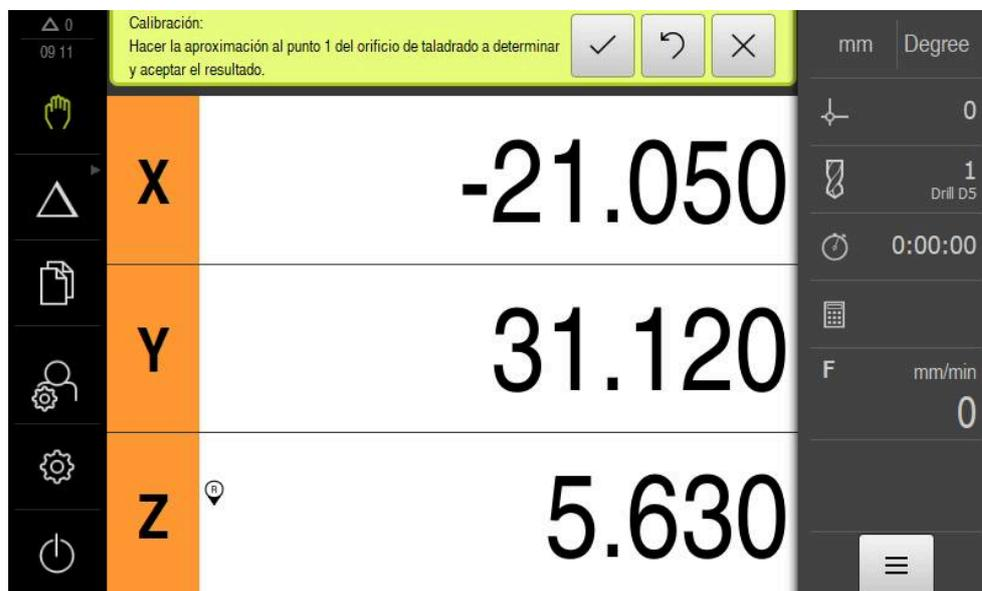
Figura 37: Paso Aproximar posiciones de calibración
