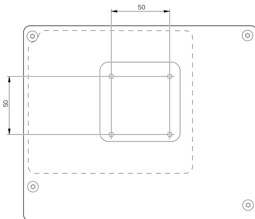
Figura 14: Dimensões da parte posterior do aparelho
