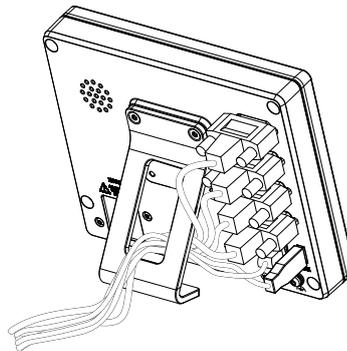
Figura 16: Passagem dos cabos no pedestal Single-Pos
