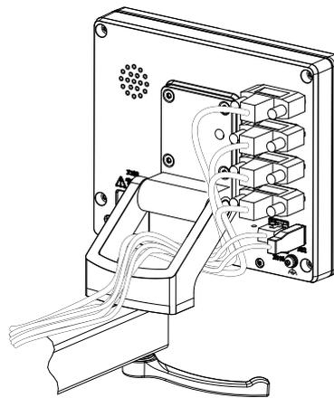
Figura 22: Passagem dos cabos no suporte Multi-Pos
