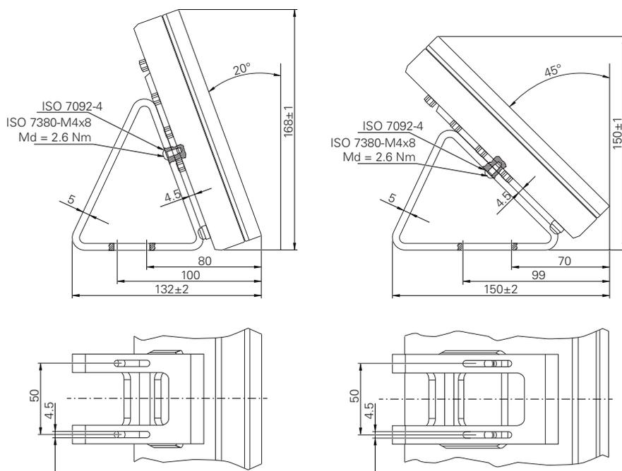
Figura 37: Dimensões do aparelho com pé de suporte Duo-Pos
