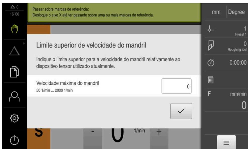
Figura 43: Diálogo **Limite superior de velocidade do mandril**
