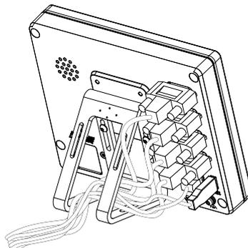
Figura 18: Passagem dos cabos no pedestal Duo-Pos
