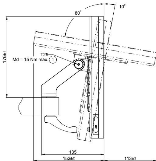
圖形 36: 含多位置固定架的產品尺寸
