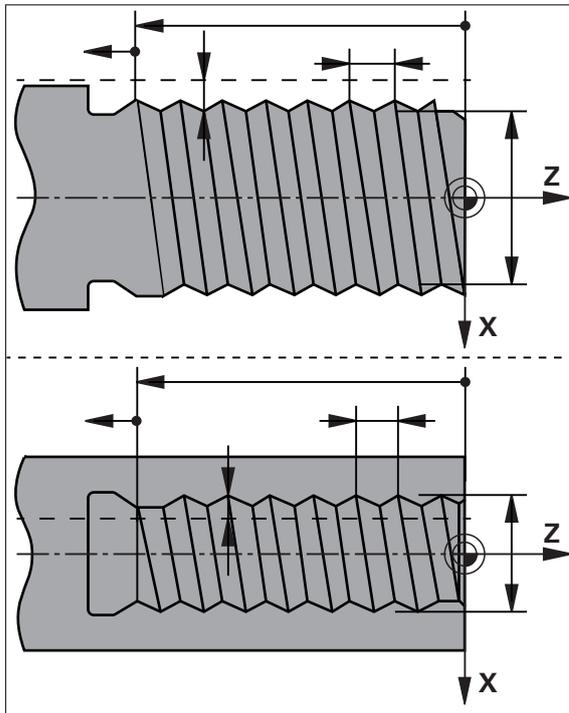
圖形 41: 螺紋切削(基本)單節的示意圖
