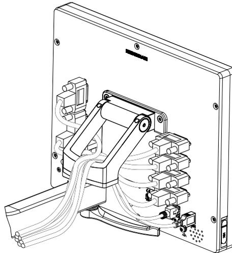
圖形 20: 多位置固定架上的纜線佈線
