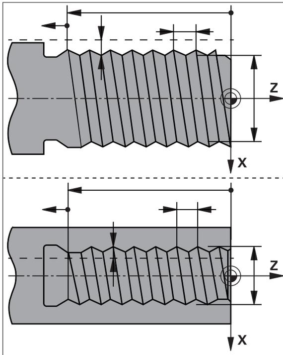
圖形 51: 螺紋切削(基本)單節的示意圖
