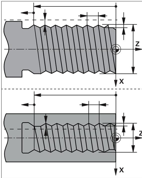
圖形 42: 螺紋切削(擴充)單節的示意圖
