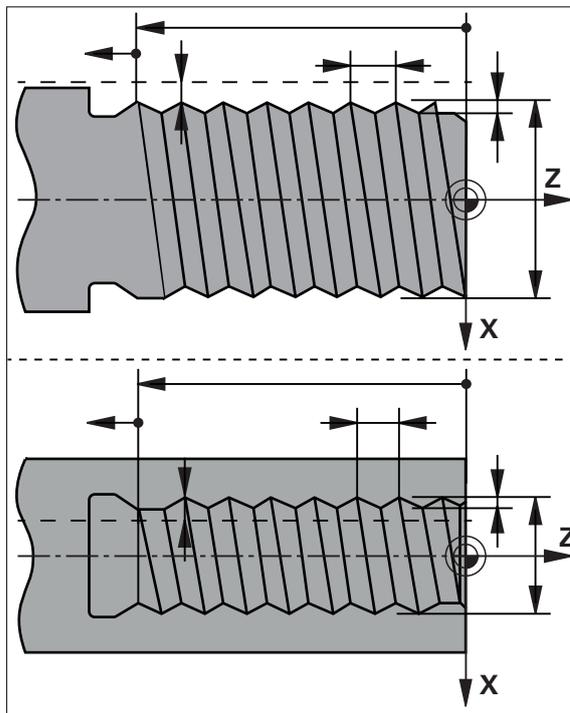
圖形 52: 螺紋切削(擴充)單節的示意圖
