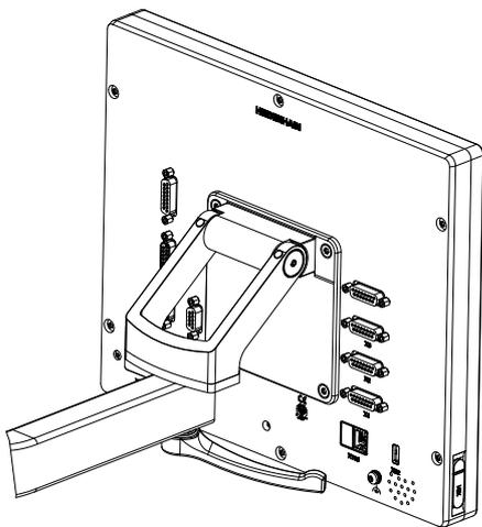
圖形 19: 產品固接在多位置固定架上
