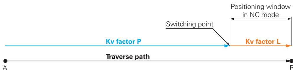
kv係數P對移動路徑有效。一旦從加速坡道計算而來的位置控制器之標稱值到達NC模式內的定位視窗，這會觸發切換至kv係數L。目標位置作為新標稱值傳輸到位置控制器。
