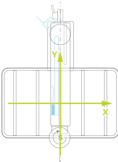
Illustration 38 : Machine de perçage radiale rapide vue de dessus, avec le sens de comptage
