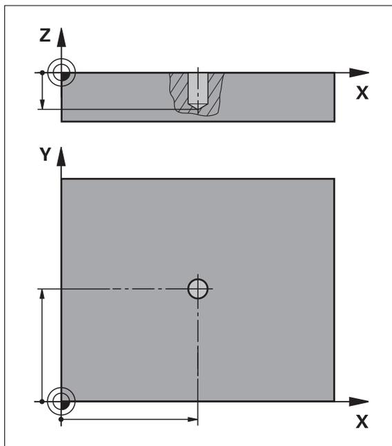
Illustration 64 : Représentation schématisée de la séquence **Perçage**
