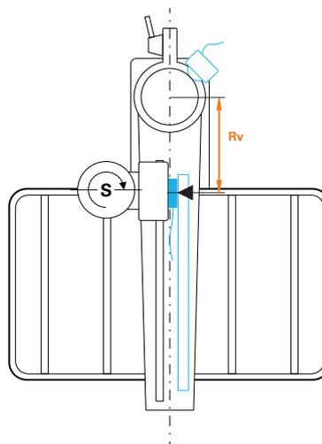
Illustration 29 : Machine de perçage radial, vue de dessus
