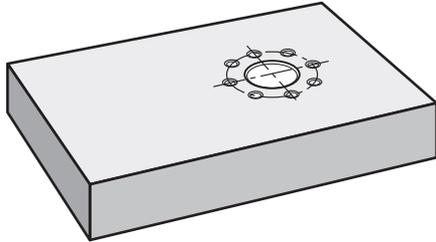
Illustration 74 : Exemple de pièces – Usinage d'un cercle de trous
