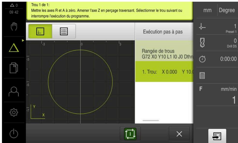
Illustration 61 : Exemple – Exécution d'une séquence MDI avec un facteur d'échelle
