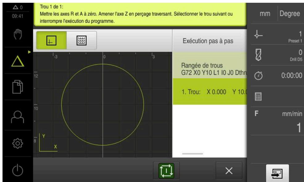
Illustration 60 : Exemple – Exécution d'une séquence MDI avec un facteur d'échelle
