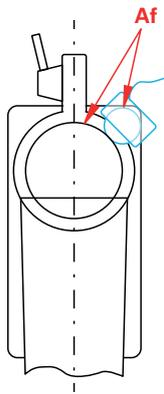
Illustration 30 : Rapport du système de mesure angulaire à l'axe de la colonne
