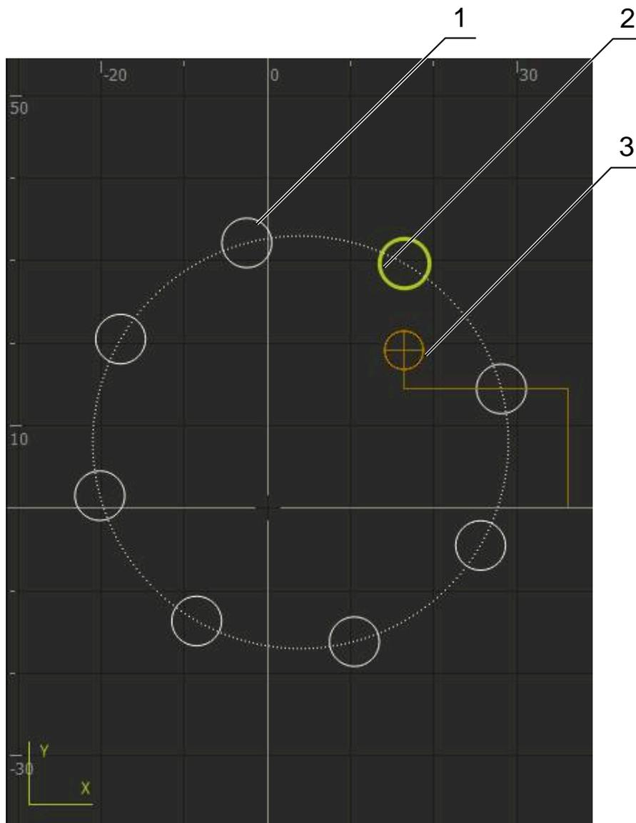
Illustration 68 : Fenêtre de simulation avec vue de contour
