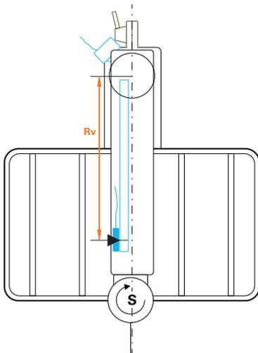
Illustration 28 : Machine de perçage radial rapide, vue de dessus
