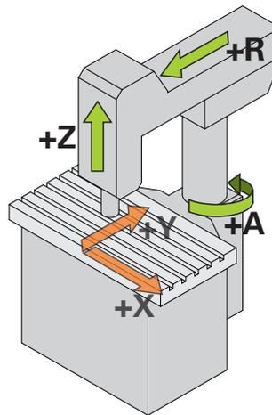
Illustration 25 : Configuration d'une machine de perçage radial rapide
