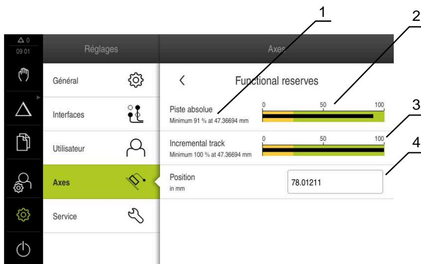
Illustration 44 : Exemple de réserves fonctionnelles pour un palpeur de mesure
