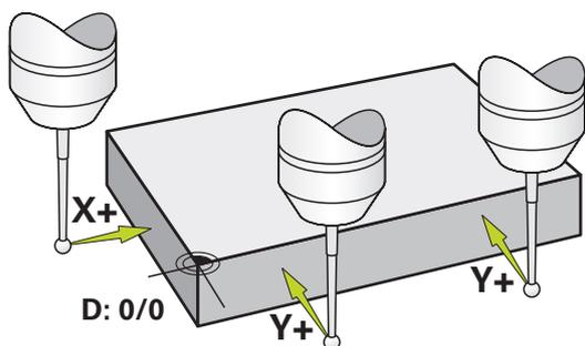
Illustration 71 : Exemple de pièce – Détermination du point d'origine
