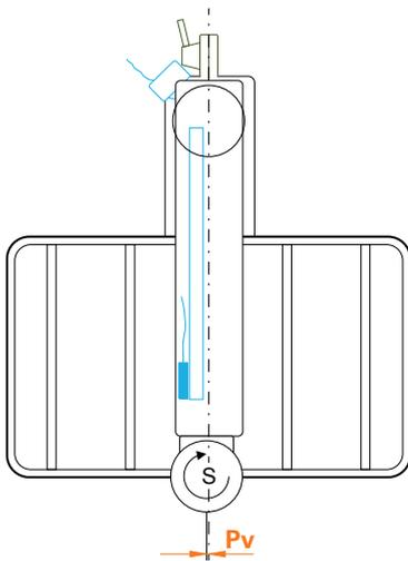
Illustration 26 : Machine de perçage radial rapide, vue de dessus
