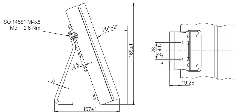
Illustration 49 : Dimensions de l'appareil avec le socle Single-Pos
