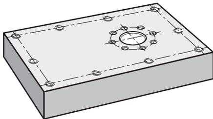
Illustration 75 : Exemple de pièce – Programmation d'un cercle de trous et d'une rangée de trous
