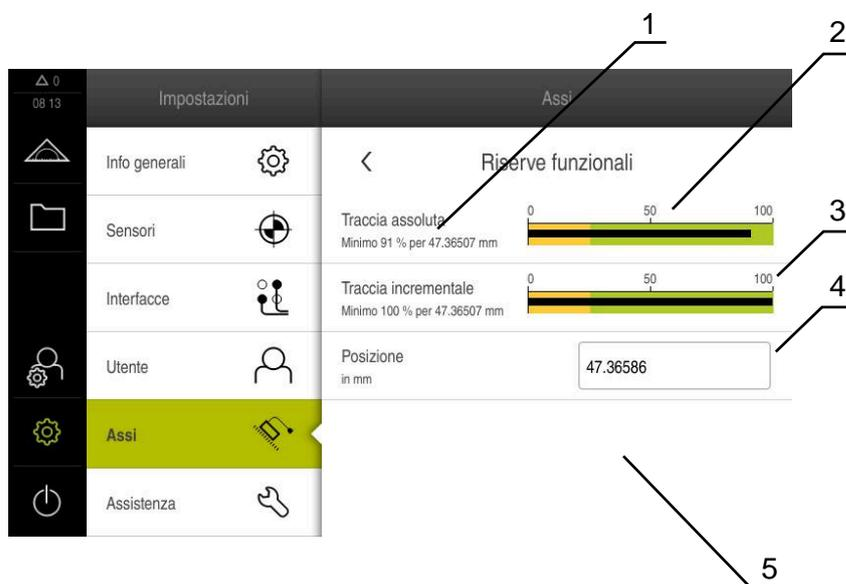
Figura 27: Esempio di riserve funzionali di un tastatore di misura
