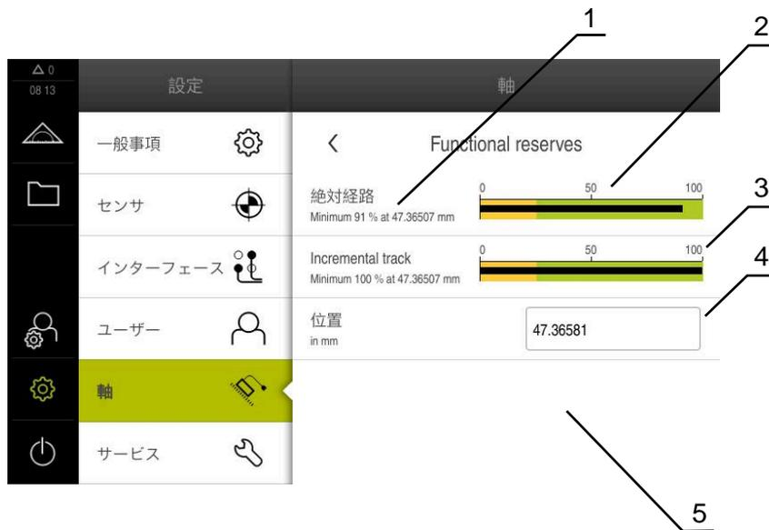
図 27: 測定プローブの機能リザーブの例
