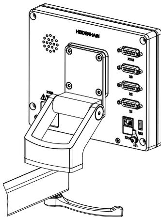
Abbildung 17: Gerät montiert am Halter Multi-Pos
